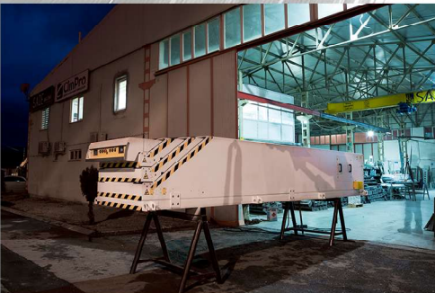
Teleskobik Konveyör Bant Kapalı boy: 6mt Açık Boy 13 mt
